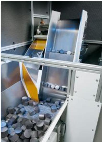
***El separador permite la carga de piezas cortadas.***
