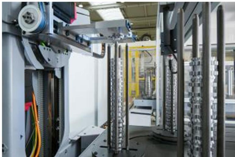
*El sistema de automatización TrackMotion garantiza un eficiente transporte de piezas y permite la instalación de apiladores para un almacenamiento compacto de los piñones de cadena acabados.*
