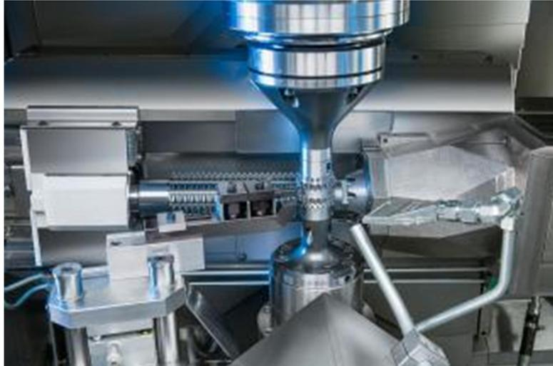
*La unidad de fresado por generación de EMAG KOEPFER proporciona un par de giro elevado y un proceso de dentado rápido.*
