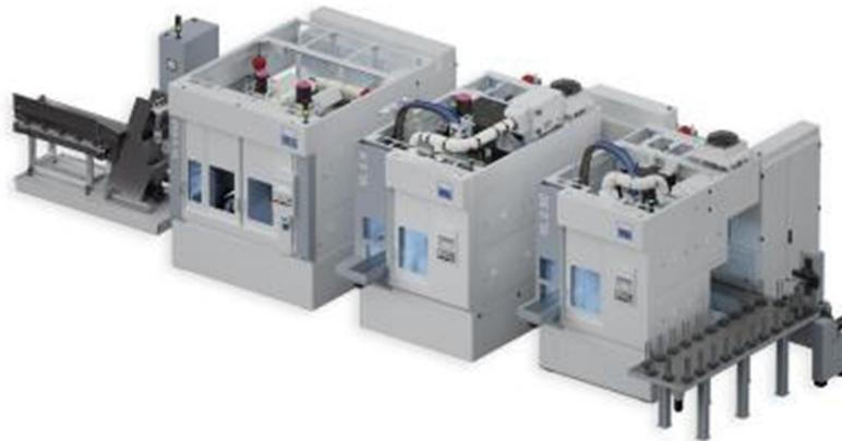
***Desde el material a granel en forma de piezas cortadas con sierra hasta engranes acabados en menos de 40 segundos: así es el nuevo sistema de fabricación de EMAG.***
