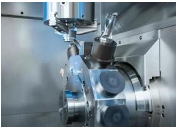
***Un potente husillo de trabajo y el portaherramientas revólver con 12 puestos garantizan un arranque de viruta rápido durante el mecanizado de piezas brutas.***
